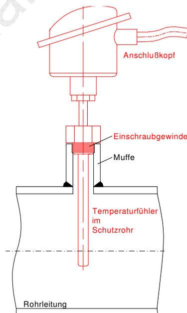
Der Aufbau eines Temperaturfühlers kann je nach Verwendung variieren. Will man z.B. den Temperaturfühler bei laufendem Betrieb tauschen können, wird noch eine zusätzliche Schutzhülse verwendet. Diese Schutzhülse wird in das Rohr eingeschweißt und danach wird der Temperaturfühler eingeschraubt.
